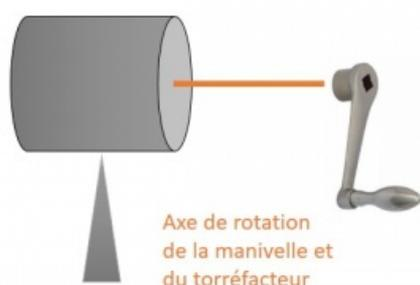
\* Pour faciliter le mouvement, adapter une démultiplication entre les deux axes de rotation, à l'aide de pignons et d'une chaîne de transmission.
