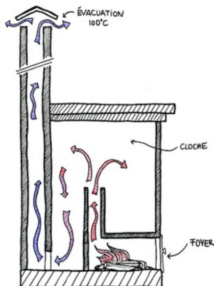
Schéma d'un poêle de masse où le circuit d'échange est une cloche.
