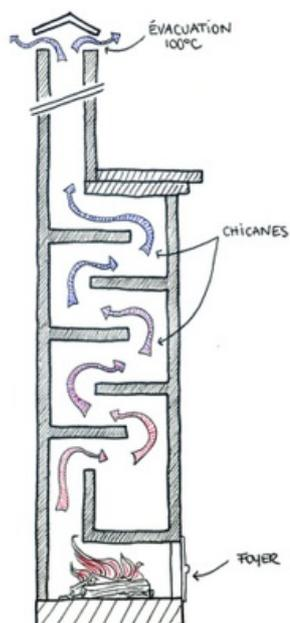
Schéma d'un poêle de masse où le circuit d'échange est composé de chicanes.
