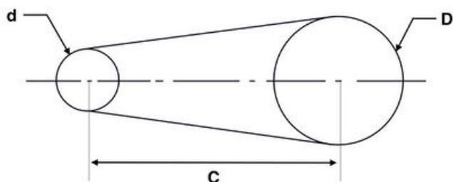
$$\text{Longeur courroie} = 2C + \frac{\pi}{2} (D + d) + \frac{(D - d)^2}{4C}$$
