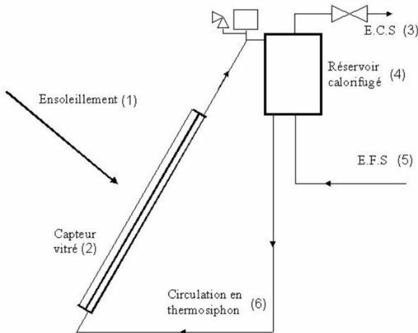
Fig 5.35 – Chauffe eau solaire à thermosiphon
