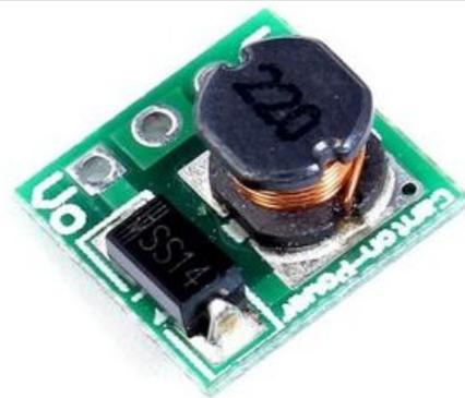
**DC-DC Module De Puissance Convertisseur Boost 1.5V**
