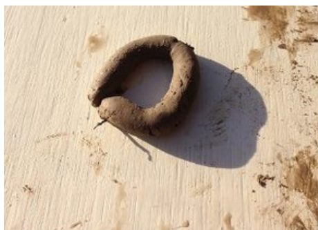
Boudin pouvant être mis en cercle = terre argileuse
