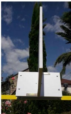
Par exemple ici, si on veut enlever l'ombre sur la partie droite, il suffit de visser les vis de la partie gauche et de dévisser les vis de la partie droite.
