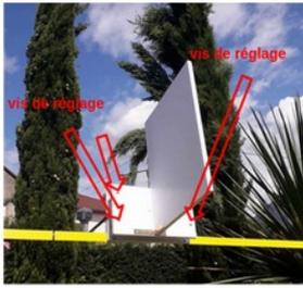
Vis de réglage du concentrateur. En vissant d'un côté, le shadowband va se rapprocher de son socle et donc générer une ombre de ce même côté.
