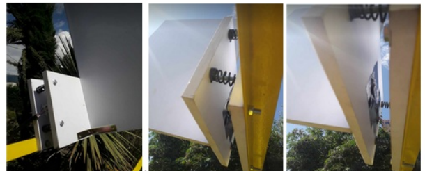
Montage du shadow band sur son support plastique, lui-même fixé sur le concentrateur
