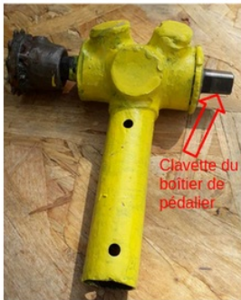
Voici ce que le boîtier de pédalier devient par la suite. Les trous dans le tubes ont été percés pour pouvoir fixer une plaque sur le dessous. Les trous des tubes peuvent être bouchés pour éviter l'eau de s'infiltrer dans les roulements.
