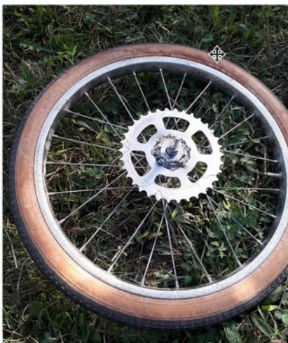
Voici la roue de vélo avec un pignon plus grand soudé sur le pignon original
