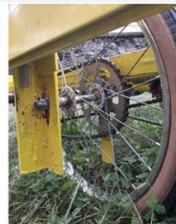
Cornières pour faire la fourche de la roue. Celles-ci sont entaillées pour pouvoir laisser passer l'axe de la roue. 2 boulons sont vissés pour serrer la roue entre les deux cornières.
