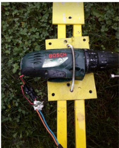
Perceuse démontée avec raccordement des câbles avec sucre électrique.
