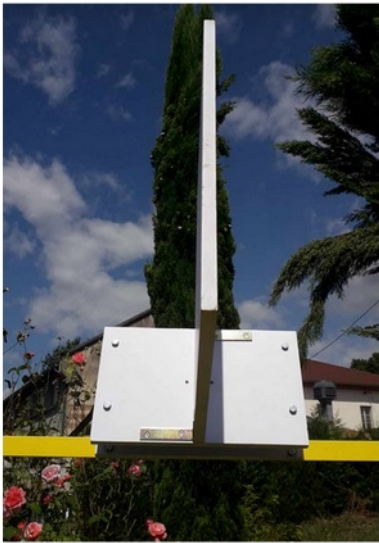
Voici le shadow band avec une photorésistance à l'ombre et l'autre au soleil (ce sont les deux petits points de part d'autre du plan orthogonal).
