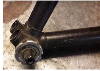
Voici un boîtier de pédalier incrusté dans un cadre vélo. Deux tubes du cadre ont déjà été disqués , il suffit de couper les deux autres. Garder au moins 10 cm sur le tube du bas pour pouvoir l'accrocher sur une plaque support par la suite.
