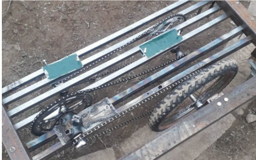
Chaîne de transmission de l'automatisme avec roue
