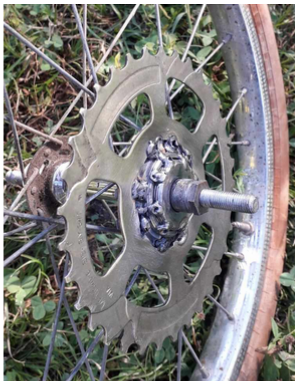
Soudure du grand pignon sur le petit pignon bien à plat et bien centré
