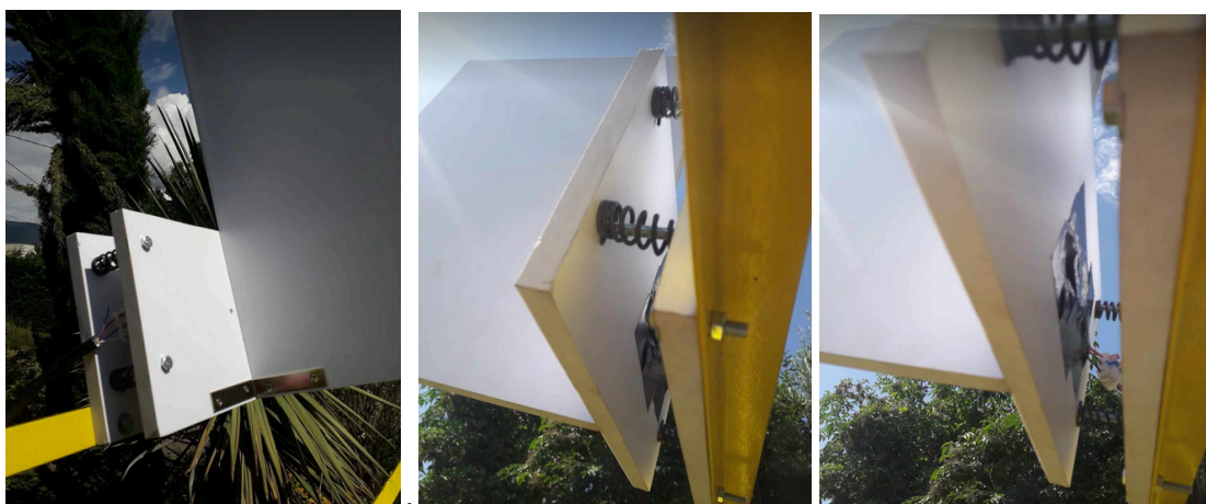
Montage du shadow band sur son support plastique, lui-même fixé sur le concentrateur
