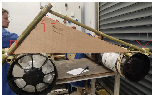
Gabarit du triangle à réaliser pour l'angle à donner au support de grille
