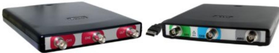
Figure D.1 : cartes TiePie HS 3 (à gauche) et HS5 (à droite) utilisées comme système d'acquisition
