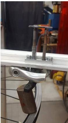
5) Mettre les ressorts autour des tiges et souder la plaque métallique aux deux tiges d'acier.
