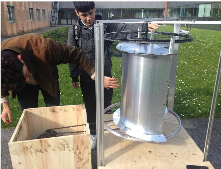
Ce manuel vise à expliquer les étapes de construction d'une éolienne domestique de type Savonius produisant de l'électricité en courant continu de l'ordre de 20 W suivant le matériel choisi.
