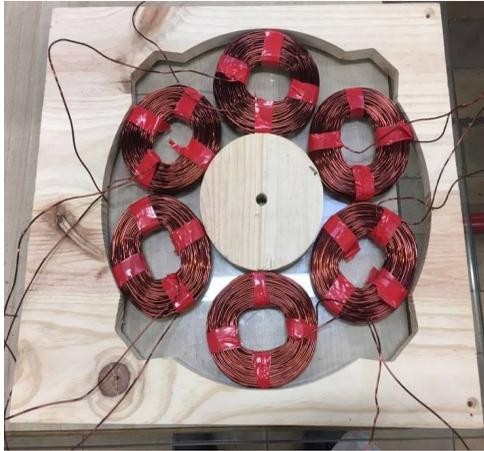
Les bobines doivent être toutes dans le même sens de bobinage.
