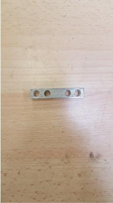
2) Usiner 4 trous dans le bloc de métal pour créer le guide. Les trous intérieurs doivent être du diamètre des tiges. Les trous extérieurs doivent être du diamètre de vos vis.
