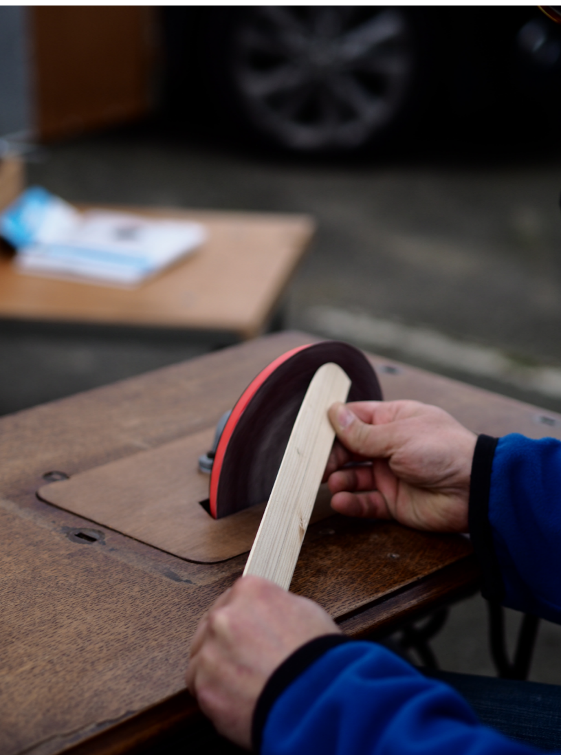
Mise en forme des pales
