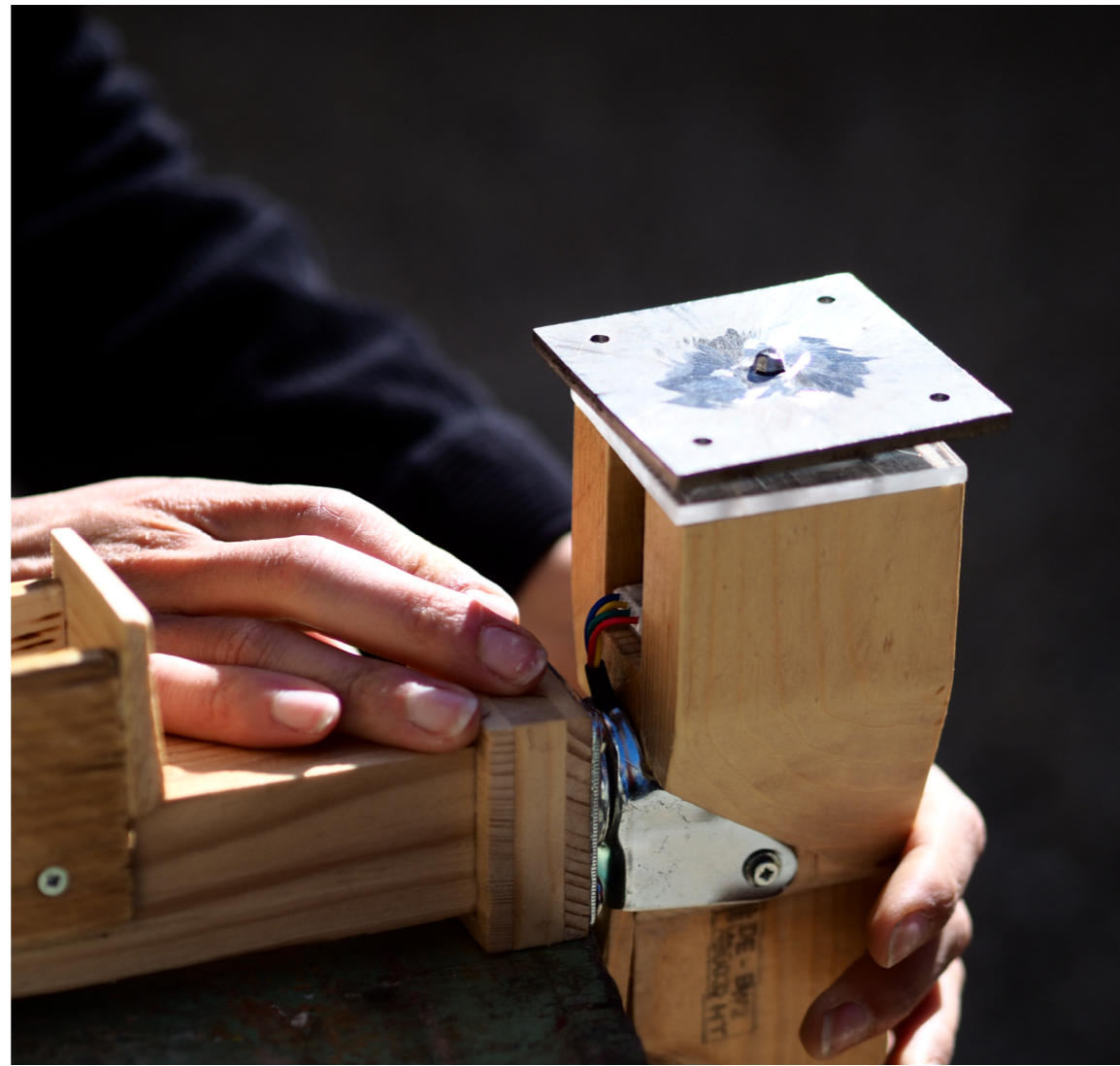
Installation du moteur avec le support soudé
