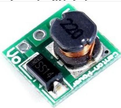
DC-DC Module De Puissance Convertisseur Boost 1.5V
